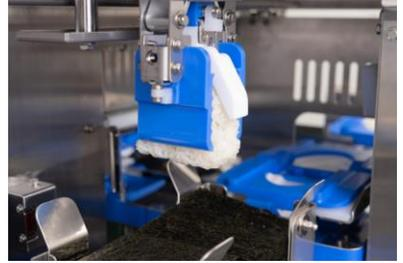
鈴茂器工が寿司ロボットやご飯盛り付けロボットで培ってきたご飯一粒一粒を傷めることなく攪拌し、空気を抱くようパラパラと成形・計量する技術を継承しております。
