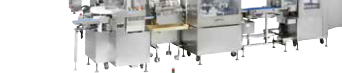
手巻き寿司包装機 手巻きおむすび、パクダンおむすび、海苔巻きシート、多彩にアレンジができる!! シートおむすび製造ライン ESS-AMB 能力：3300個/時
